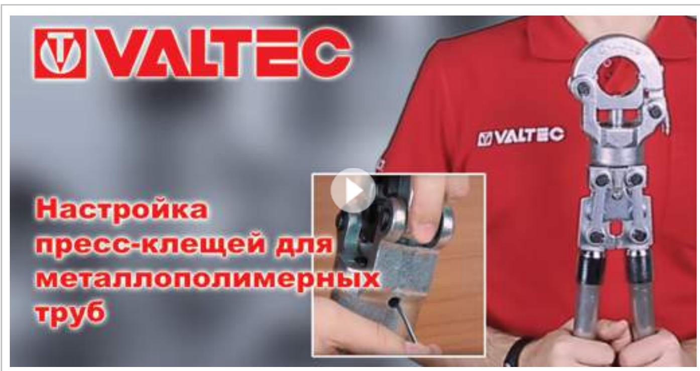
Настройка пресс-клещей для металлополимерных труб.
