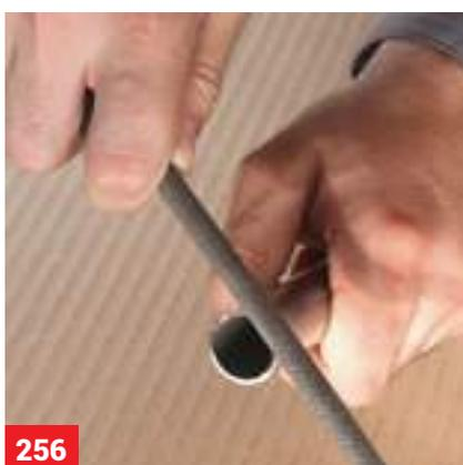
Наружный грат можно снять с помощью напильника.
