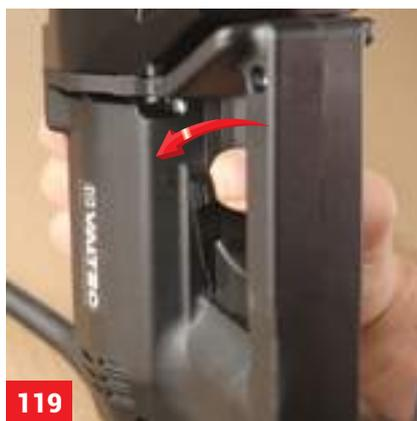
В инструменте VT.572111 о полном смыкании губок свидетельствует изменение звука (работает фрикционная муфта). Следует отпустить кнопку пуска, перевести переключатель в положение реверса и, снова нажав кнопку пуска, отвести толкающие ролики.
