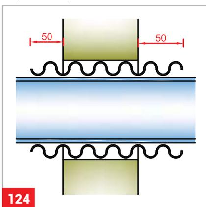
В местах прохода металлополимерных труб через стены, перегородки и перекрытия труба должна быть заключена в защитный пластиковый гофрированный кожух.
