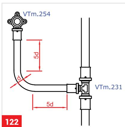
Не допускается устанавливать пресс-соединители ближе, чем 5D от начала изгиба трубы.
