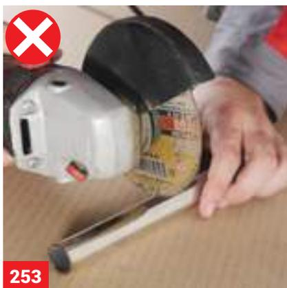
Разрезание труб болгаркой не допускается, т.к. может привести к разрушению сварного шва трубы.
