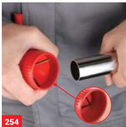
Торец трубы, подлежащий введению в фитинг, следует обработать наружным и внутренним гратоснимателем. Внутренний грат может привести к попаданию в воду мелких частиц металла, а наружный грат может повредить уплотнительные кольца фитинга.
