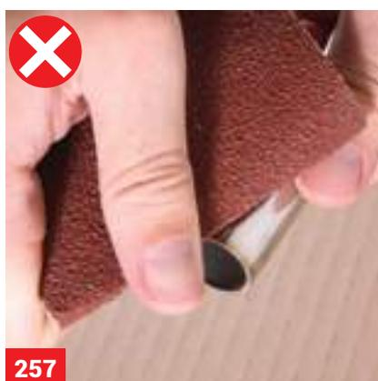
Попытка обработки торца трубы вручную с помощью наждачной бумаги может привести к травме руки.
