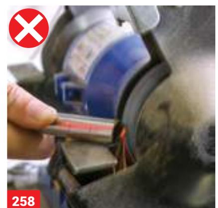
Обработка торца электроточилом или болгаркой не допускается из-за опасности перегрева трубы и повреждения сварного шва.
