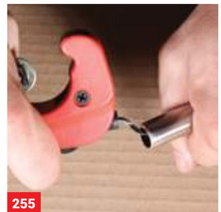
Внутренний грат можно удалить гратоснимателем, встроенным в труборез VTi.735.
