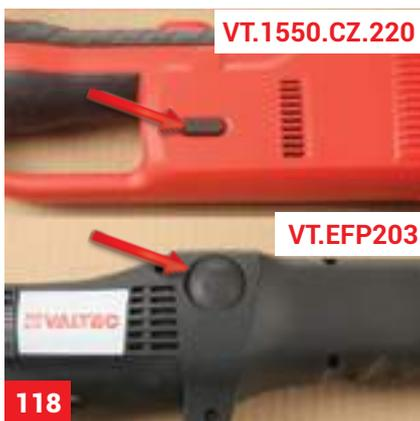
Если в процессе опрессовки инструментами VT.1550.CZ.220 и VT.EFP203 произошла ошибка, нужно отпустить кнопку пуска и нажать кнопку принудительного возврата.
