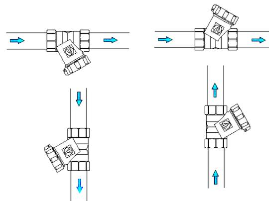
5.2. При направлении потока снизу-вверх, необходимо выполнить горизонтальный участок для правильной установки фильтра, иначе установка фильтра приведет к засорению нижнего отвода (угольника или тройника) трубопровода. Если горизонтальный участок выполнить не представляется возможным, следует использовать фильтр VT.386.
