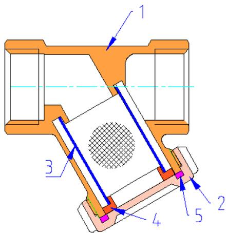
Фильтр состоит из корпуса 1, заглушки 2, фильтроэлемента 3, центрирующей втулки 4 и прокладки 5. Корпус и заглушка выполнены из горячепрессованной, никелированной латуни марки CW617N. Центрирующая втулка служит для фиксации фильтроэлемента в фильтровальной камере и
