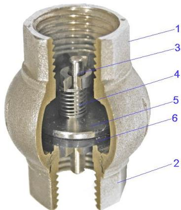
Клапан состоит из составного никелированного корпуса (поз. 1 и 2) из латуни CW 617N, в котором расположен подвижный золотник, состоящий из латунного штока (3), латунных золотниковых тарелок (5), между которыми помещена золотниковая прокладка из EPDM (6). Возврат золотника в седло обеспечивается пружиной (4) из нержавеющей стали AISI 304. Латунные детали золотника имеют гальванопокрытие из никеля.
