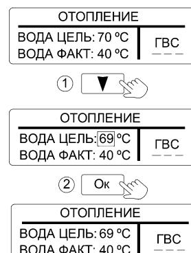
Рисунок 7. Настройка температуры теплоносителя
