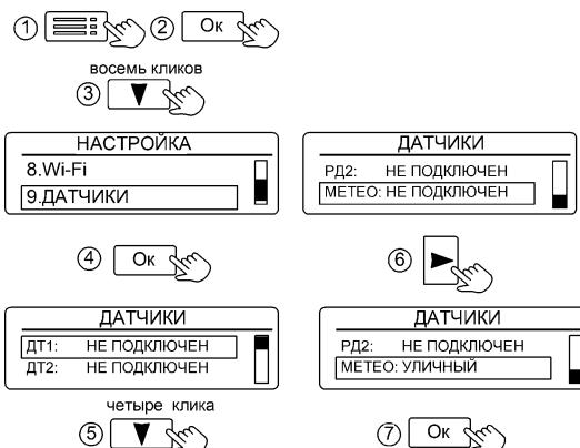
Рисунок 25. Настройка подключения к метеосерверу.
