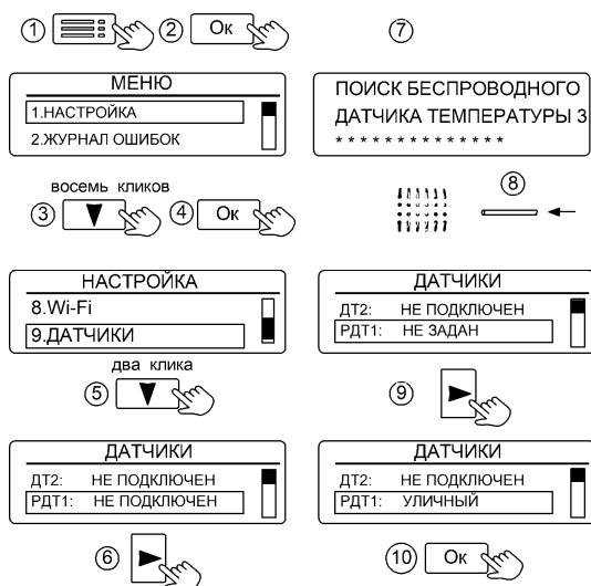
Рисунок 24. Настройка радиодатчиков
