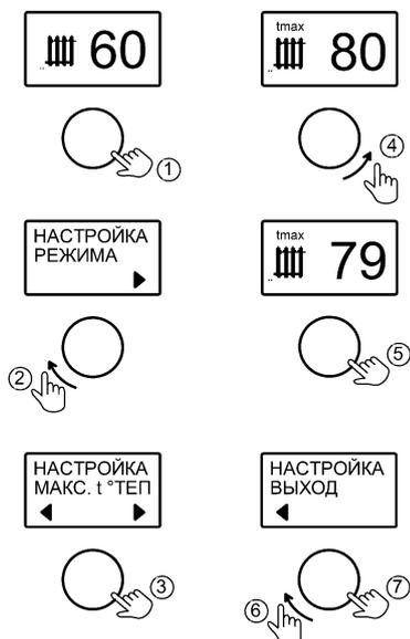
Рисунок 9. Настройка максимальной температуры теплоносителя
