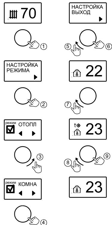
Рисунок 5. Выбор и настройка температуры режима «КОМНАТНЫЙ»
