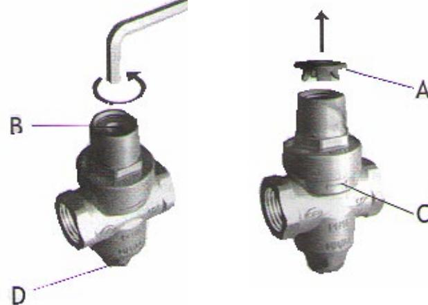
6.5. Настройка редуктора производится при расходе, близком к нулевому, но не нулевому. Это значит, что все водоразборные краны системы должны быть закрыты, а на одном из приборов оставлен минимально возможный струйный расход (расход, при котором выходящая из излива струя не разделяется на отдельные капли).
